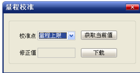
图 5.6 量程校准-校准量程上限
