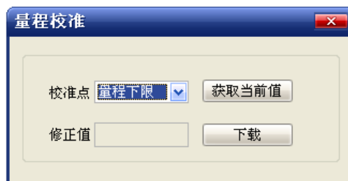
图 5.5 量程校准-校准量程下限
